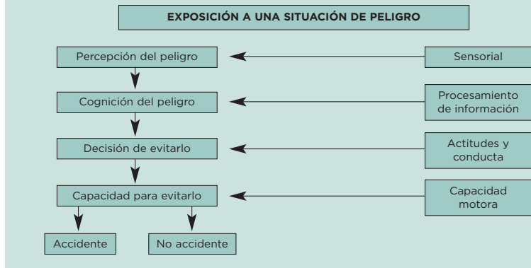
Figura 3. Modelo secuencial de la producción de un accidente (Smith y Beringer, 1987)
